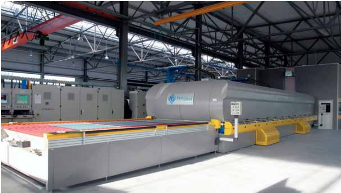
Linia do hartowania szkła budowlanego
