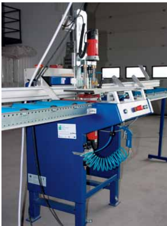
Wiertarka pionowa do jednoczesnego, współosiowego wykonywania otworów w przewodnicach
