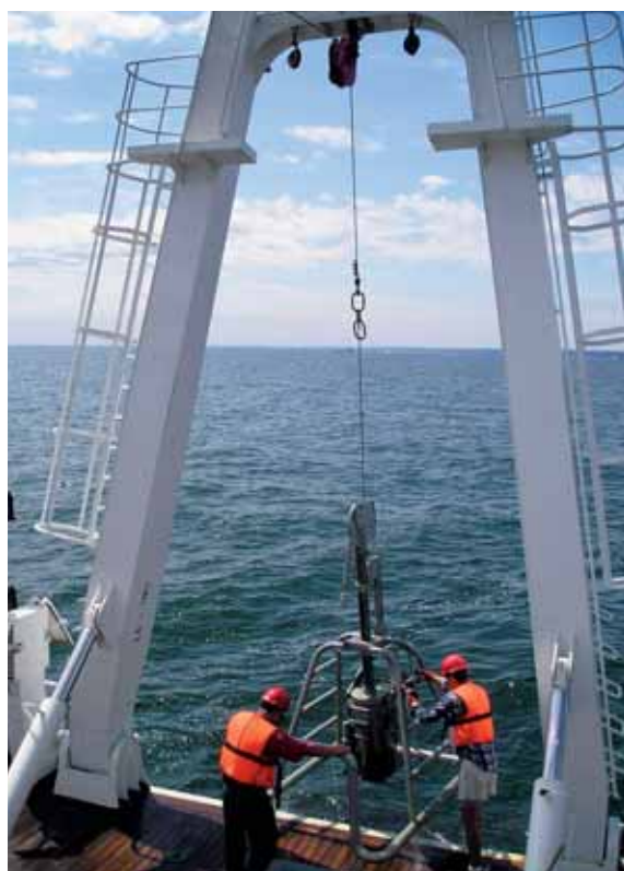
Pobór urządzeniem Box Cover prób osadów powierzchniowych do badań geologicznych Bałtyku Południowego
