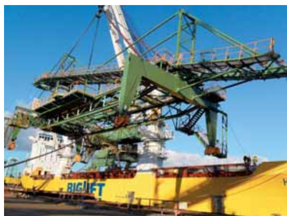
Element taśmociągu (conveyor'a) ładowany na statek typu "heavy lift" (ciężarowiec) przed ekspedycją na antypody
